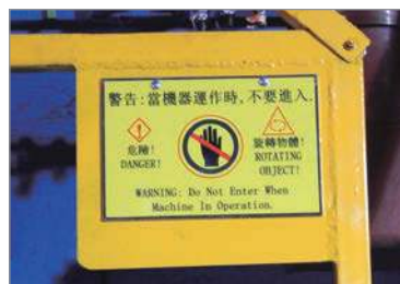
禁止接觸或進入機器的告示牌
