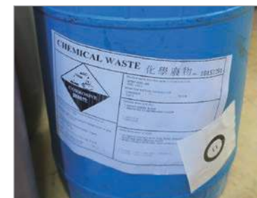
為腐蝕物品貼上標籤及警告
