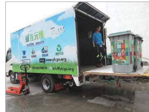
🌿 操作人員觀察升降台是否操作正常
