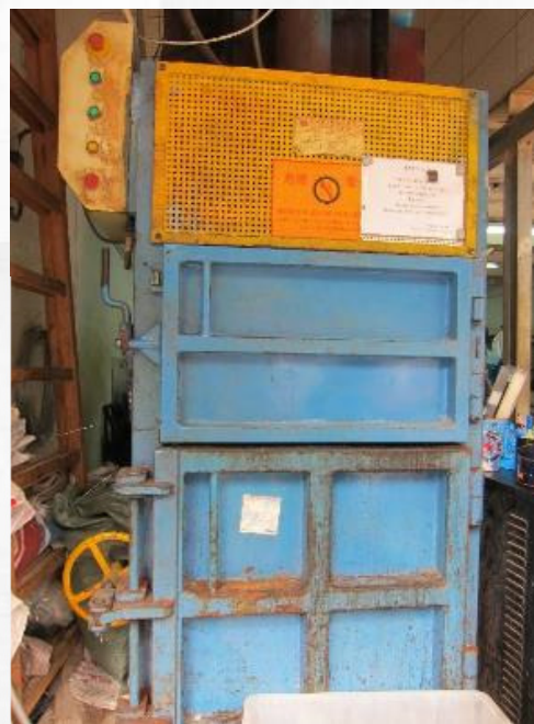
機械設有有效護罩及緊急停機掣
