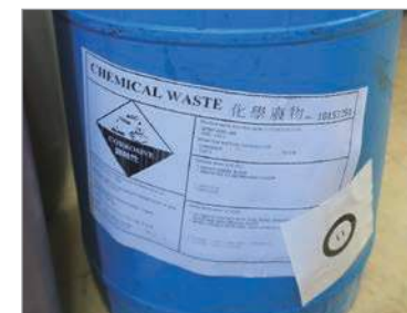
為腐蝕物品貼上標籤及警告
