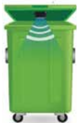
回收桶內安裝超聲波存量感應器
