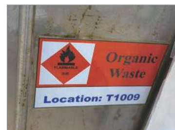
易燃物品存放在鐵箱內，並貼有標籤
