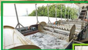
▲俊成環保有限公司新購建的塑膠清洗系統，可以自動分辨PET及HDPE塑膠，大大增加回收效率。
