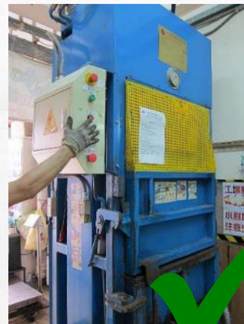
機械設有有效護罩及緊急停機掣
