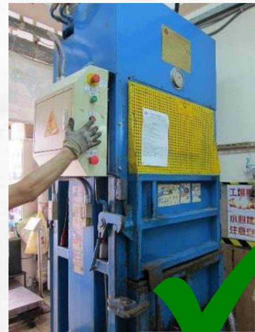
機械設有有效護罩及緊急停機掣
