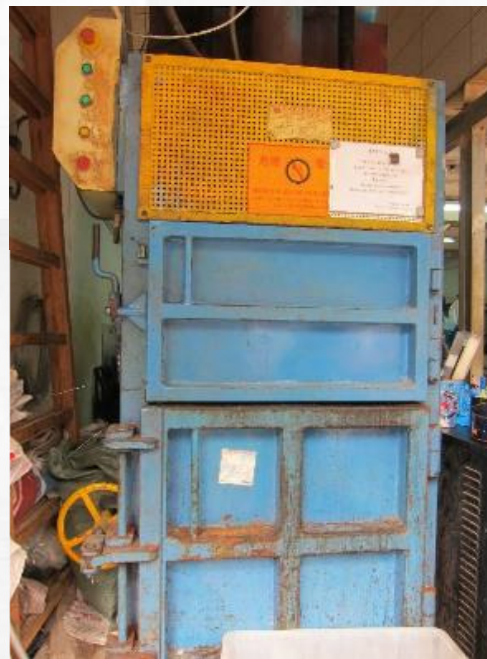
機械設有有效護罩及緊急停機掣
